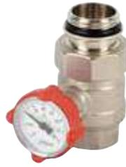
Vannes à bille pour passage total de l'eau, actionnement par une poignée papillon, complétées par un thermomètre à immersion avec bulbe arrière amovible.
