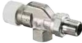
Pour l'équilibrage hydraulique manuel au niveau du radiateur dans des installations de chauffage central et de rafraîchissement en circuit fermé. Montage sur l'aller. Le mécanisme AV 9 intégré permet un pré réglage progressif pour adapter le débit au besoin calorifique. Les robinets thermostatiques AV 9 sont disponibles dans les versions suivantes : équerre, droit, équerre inversé et angle. Le corps du robinet est en laiton et la surface est nickelée. La tige est en acier inoxydable.
