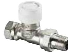
Pour l'équilibrage hydraulique manuel au niveau du radiateur dans des installations de chauffage central et de rafraîchissement en circuit fermé. Montage sur l'aller. Le mécanisme AV 9 intégré permet un pré réglage progressif pour adapter le débit au besoin calorifique. Les robinets thermostatiques AV 9 sont disponibles dans les versions suivantes : équerre, droit, équerre inversé et angle. Le corps du robinet est en laiton et la surface est nickelée. La tige est en acier inoxydable.
