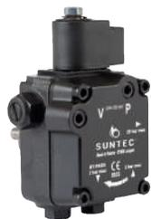
La série AL comporte une électrovanne en ligne incorporée assurant la fonction de coupure. Dans les installations bitubes, la purge est automatique. Dans les installations monotubes, la purge est réalisée en desserrant la prise de pression jusqu'à évacuation complète de l'air.
