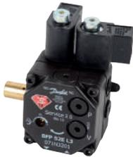
Pompe à fioul série Diamond compacte 2 allures avec régulateur à membrane, filtre cartouche et réglage de la pression sur le devant, 1 sortie gicleur. Avec 2 électrovannes de coupure. Réglage pression 7 à 25b. Les pompes à huile de service 2.0 de Danfoss ont pour vocation de durer 10 fois plus longtemps, lorsqu'elles sont installées dans des applications critiques (avec des conditions de charge lourde, par exemple).
