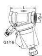
STAP est un régulateur de pression différentielle dont le rôle est de maintenir une pression différentielle constante pour assurer une régulation stable et précise, réduire le risque de fonctionnement bruyant des vannes de régulation et faciliter l'équilibrage et la mise en route. En raison de sa précision élevée et de son faible encombrement, le régulateur STAP est particulièrement indiqué pour être utilisée du côté secondaire des installations de chauffage et de climatisation.
