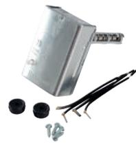
Les dispositifs de réglage de température L4064B conviennent à tout système de chauffage à air pulsé Ils agissent sur le brûleur lors du passage en limiteur et sur le ventilateur pour la régulation du soufflage Si la régulation et la sécurité sont réalisés l'une sur la phase l'autre sur le neutre, alors le cavalier sécable doit être coupé. Attention dans ce cas il ne pourra jamais être remplacé.
