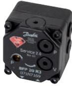
Pompe à fioul série Diamond compacte avec régulateur à membrane, filtre cartouche et réglage de la pression sur le devant, 2 sorties gicleur. Sans électrovanne de coupure. Les pompes à huile de service 2.0 de Danfoss ont pour vocation de durer 10 fois plus longtemps, lorsqu'elles sont installées dans des applications critiques (avec des conditions de charge lourde, par exemple). Réglage frontal 7 à 20b
