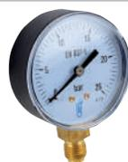
Manomètre ABS, sec non remplissable Ø63mm, 0/25bar, type 116
