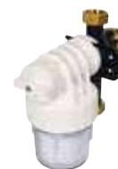
Doseur hydrodynamique proportionnel de polyphosphates alimentaires pour traitement anticalcaire et anticorrosion des chaudières avec filtre en acier inoxydable intégré 90 microns
