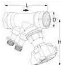
Vanne pour les installations de chauffage et de refroidissement
