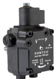
La série ALE comporte une électrovanne en ligne incorporée munie d'un clapet de retour assurant la fonction de coupure et la décharge de la ligne gicleur.
