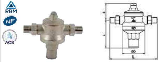
Réducteur de pression réglable en M3/4", avec un fonctionnement à membrane à 2 sièges, en acier inox, avec action anti-coup de bélier.
