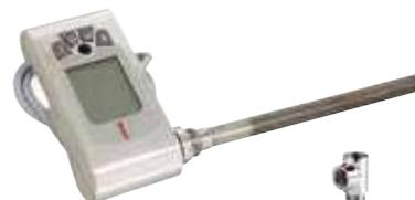
Fonctions : Programmation hebdomadaire / Vacances / Détection ouverture fenêtre / Intelligence Température Control System / Blocage clavier sécurité enfant, Fil pilote 6 ordres : Manuel / Timer / Auto / Confort / Nuit / Eco / Tension : 230V / Indice de protection : classe II, IP44 / Longueur câble : 1,2m
