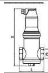
Séparateur d'air solaire modèle « VENT » pour microbulles
