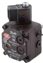
Pompe spéciale série Diamond qui s'utilise avec un gicleur fioul de type LE ou avec un préchauffeur de type LE, 2 sorties gicleur. Comprend une électrovanne de coupure. Fonction antigoutte. Les pompes à huile de service 2.0 de Danfoss ont pour vocation de durer 10 fois plus longtemps, lorsqu'elles sont installées dans des applications critiques (avec des conditions de charge lourde, par exemple). Réglage frontal 7 à 20b
