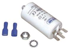
Sous tension en permanence, ils assurent au moteur une alimentation d'une phase auxiliaire. Le voltage mentionné sur le corps des condensateurs n'a aucun rapport avec la tension secteur. Le remplacement par un condensateur de voltage supérieur est possible, mais pas l'inverse. Si le condensateur de remplacement affiche une capacité en micro farad ( $\mu\text{F}$ ) en plus ou moins de 20%, le moteur peut démarrer mais fournit un couple et une vitesse insuffisante, préjudiciable à sa longévité.
