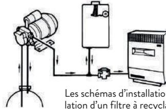
Les schémas d'installation 2 et 3 nécessitent l'installation d'un filtre à recyclage code **903462**.
