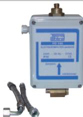
Pompe relais servant à alimenter un ou plusieurs brûleurs à pulvérisation placés à des niveaux différents. Un détendeur de pression doit être placé devant le brûleur pour protéger le presse-étoupe contre une pression excessive. Dans ce cas, pendant les arrêts du brûleur, la pompe reste sous tension mais ne fournit pas.
