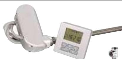
Fonctions : Programmation hebdomadaire / Vacances / Détection ouverture fenêtre / Intelligence Température Control System / Blocage clavier sécurité enfant, Fil pilote 6 ordres : Manuel / Timer / Auto / Confort / Nuit / Eco / Tension : 230V / Indice de protection : classe II, IP44 / Longueur câble : 1,2m
